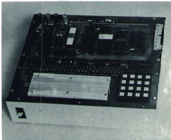
Microcomputer didattico MMD1 della E.L.I.
