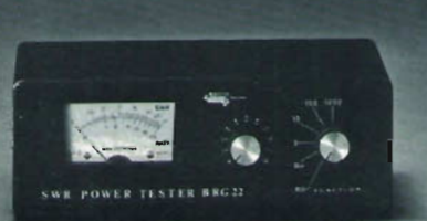
Rosmetro Wattmetro BRG-22
