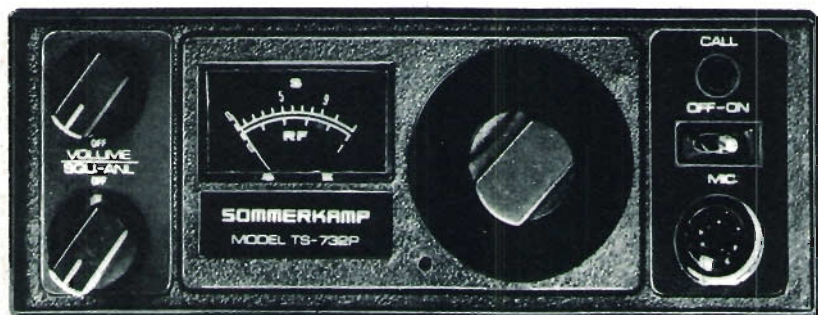
TS - 732 P 5 W - 32 canali - 11 - 16 Vcc e 110/220 Vca
